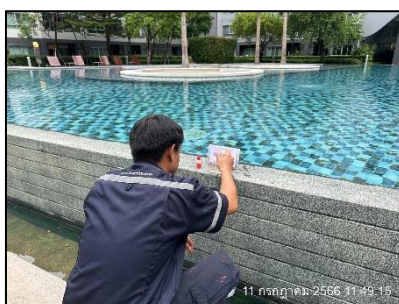
ภาพที่ 4.4-2 การตรวจวัด pH และ Free Chlorine สระว่ายน้
