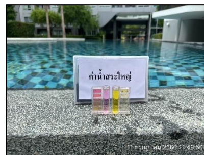
ภาพที่ 4.4-2 การตรวจวัด pH และ Free Chlorine สระว่ายน้
