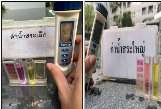
ภาพที่ 33 ตรวจค่า pH และ CL ของสระว่ายน้ำ
